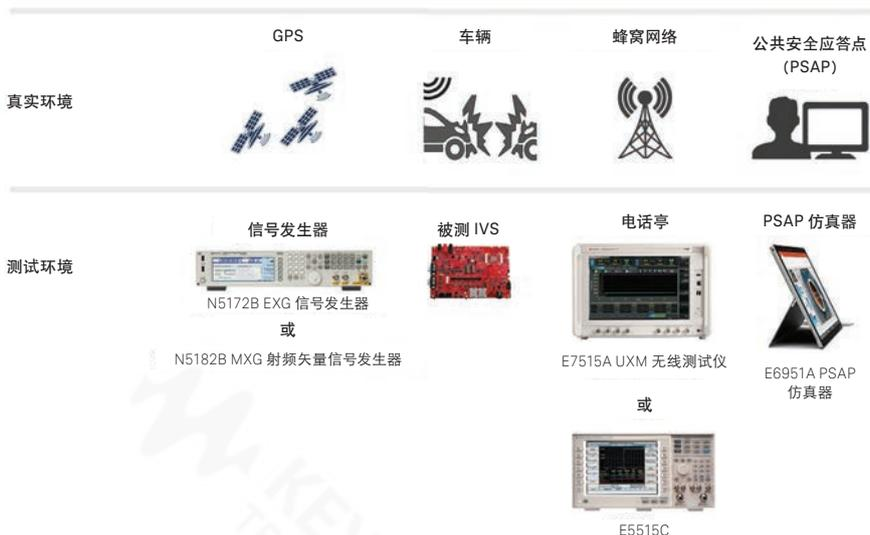
右图显示了 eCall 模块功能测试推荐的仪器装置。根据 N5172B EXG 的配置，您可以选择生成静态 GNSS 信号或动态 GNSS 信号。请参阅《Keysight eCall 一致性测试解决方案配置指南》(5992-1726EN) 了解详细信息。
